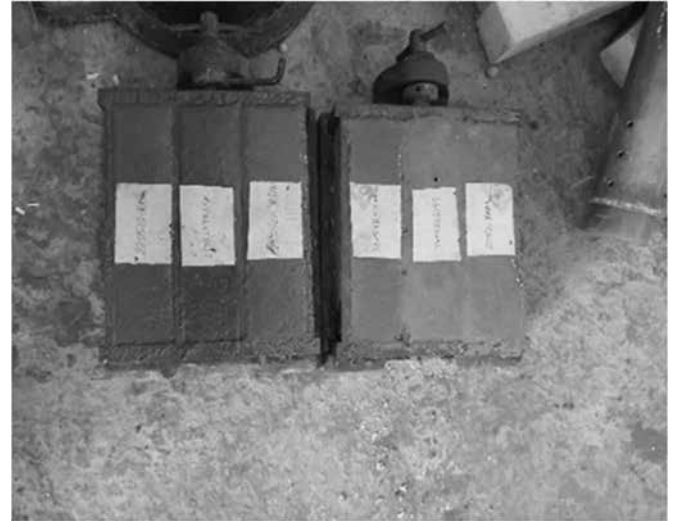
Hình 5. Chế tạo mẫu thí nghiệm xác định chỉ số hoạt tính cường độ với xi măng
