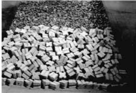
Hình 4. Lớp đầu tiên được đặt không đều [YAGCI et al., 2003]
