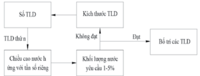
Hình 8. Sơ đồ quy trình thiết kế TLD
