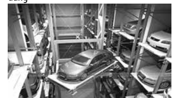
Hình 4. Hệ thống đỗ xe kiểu thang nâng
