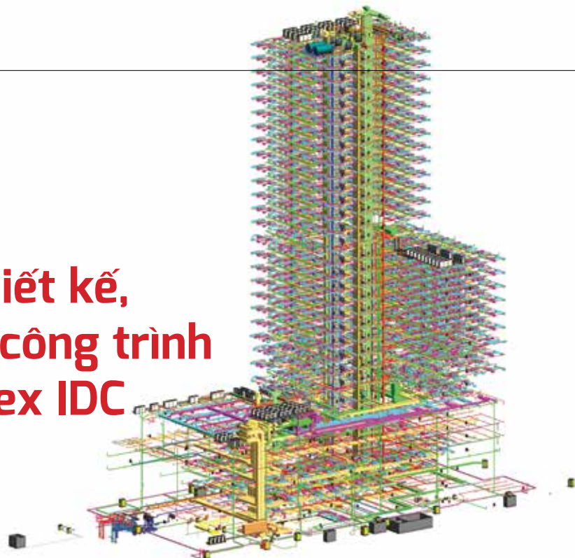
Hệ thống MEP Tòa nhà thương mại dịch vụ World Trade Center Tower Becamex IDC.
