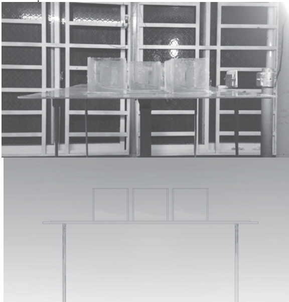
Hình 9. Hình dạng sóng chất lỏng ở thời điểm khoảng 3.0s được kích tải điều hòa
