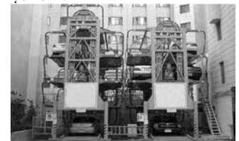
Hình 2. Hệ thống đỗ xe kiểu xoay vòng đứng
