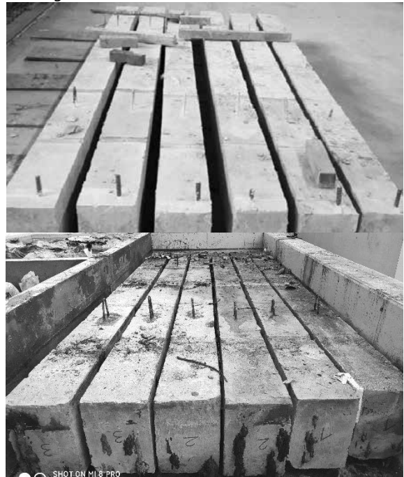
Hình 2. Mẫu dầm trước và sau khi bị ăn mòn
