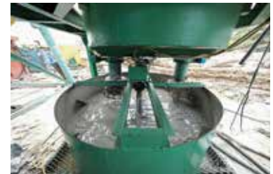
Hệ thống bơm áp suất và thiết bị khuấy trộn thi công Jet Grouting.
