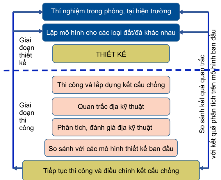
Hình 3. Các thông tin cần thiết để quyết định lựa chọn và điều chỉnh kết cấu chống [9].
