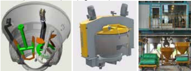
Hình 22. Hệ thống máy trộn SKAKO được lắp đặt tại nhà máy bê tông Thành Hưng
