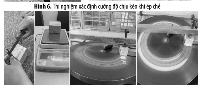
Hình 7. Thí nghiệm xác định độ mài mòn
