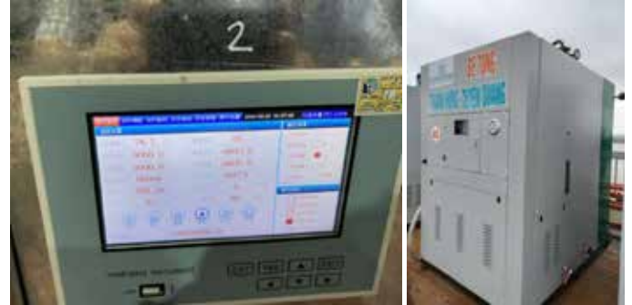
Hình 23. Thiết bị bảo dưỡng nhiệt ẩm tại
