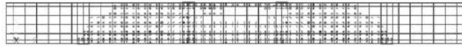
Hình 10. Hình dạng vết nứt dầm tại thời điểm P_{449} = 112,5 \text{ kN} dầm BTCT ULT có
