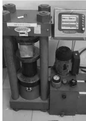
Hình 4. Thí nghiệm xác định cường độ chịu nén
