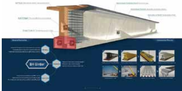
Hình 12. Dầm T cải tiến do Công ty Towoong (Hàn Quốc) nghiên cứu, thử nghiệm và áp dụng.
