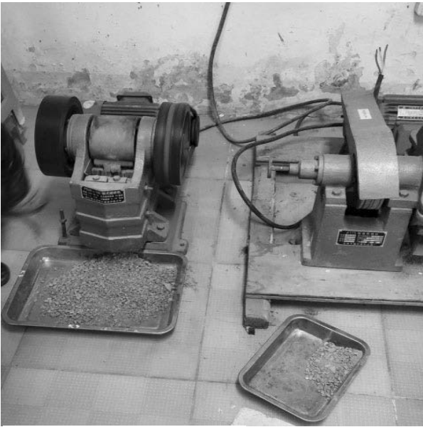
Hình 2. Nghiền phế thải tường xây tạo hạt thô
