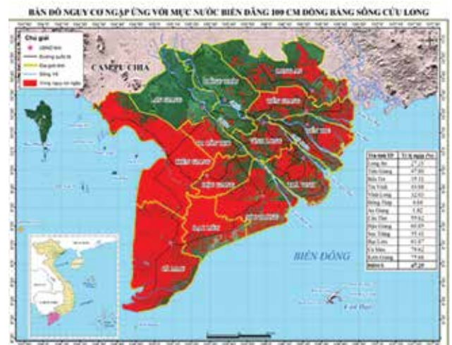
Hình 8. Bản đồ nguy cơ ngập ứng với kịch bản mực nước biển dâng 100 cm, khu vực Đồng bằng sông Cửu Long Nguồn: http://vnma.gov.vn
