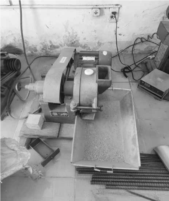
Hình 3. Nghiền phế thải tường xây tạo hạt mịn
