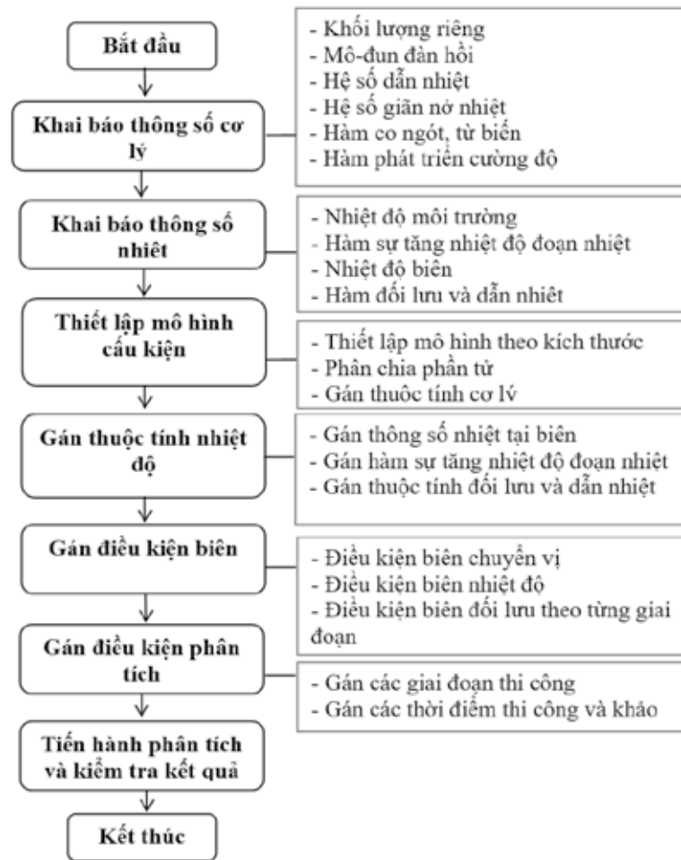
Hình 1.3. Thuật toán phân tích nhiệt theo phương pháp phần tử hữu hạn cho khối bê tông
