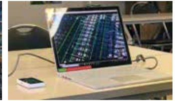
Hình 7. Chia sẻ hình ảnh kiểm tra thực tế tại hiện trường nhìn qua kính HoloLens với một bên không có mặt tại công trường thi công thông qua kết nối Internet (Hình ảnh tham khảo từ tài liệu giới thiệu sản phẩm của Công ty Informatix Inc.).
