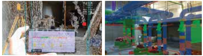
Hình 9. Các kích thước đã đo được tự động xuất ra dưới dạng một bản báo cáo ở một thiết bị khác được kết nối qua Internet (Hình ảnh tham khảo từ tài liệu giới thiệu sản phẩm của Công ty Informatix Inc.).
