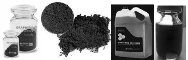
Hình 2. Graphene Oxide ở hai dạng là dung dịch và bột
