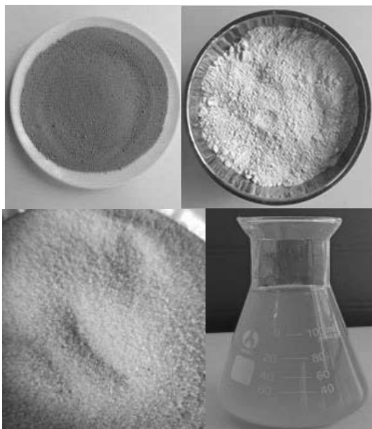
Hình 6. Các loại vật liệu khác (silica fume, xỉ lò cao nghiền mịn, cát thạch anh và phụ gia dẻo)
