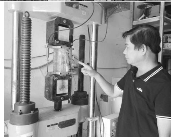
Hình 7. Kiểm tra cường độ nén và kéo UHPC
