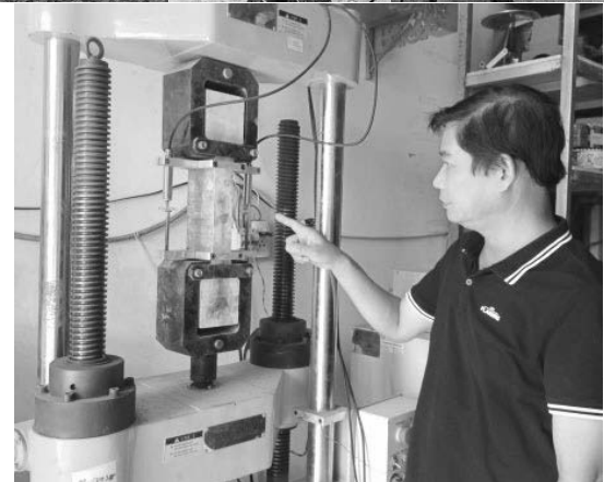
Hình 7. Kiểm tra cường độ nén và kéo UHPC
