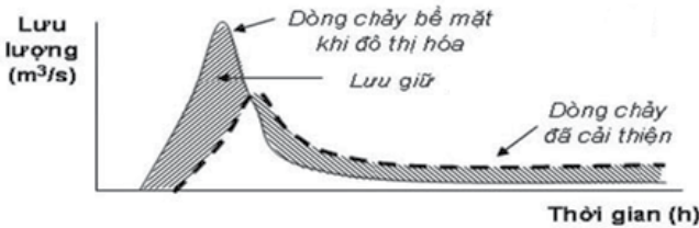
Hình 2. Đồ thị miêu tả lượng nước bề mặt được giữ lại và trở về với trạng thái tự nhiên nhờ áp dụng giải pháp thoát nước bền vững [1]
