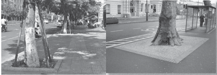
Hình 4. Hình ảnh gốc cây lát gạch thường và gốc cây lát gạch thấm nước [7]
