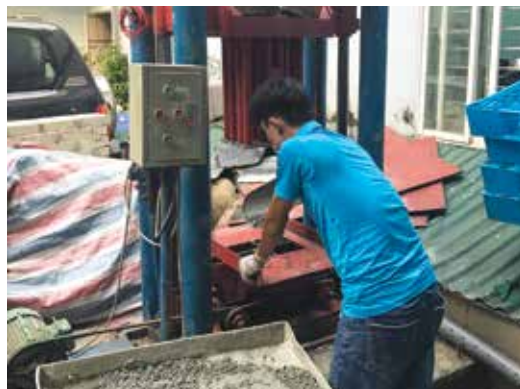
Gạch không nung sử dụng 30-40% bùn vôi thải của nhà máy sản xuất giấy
