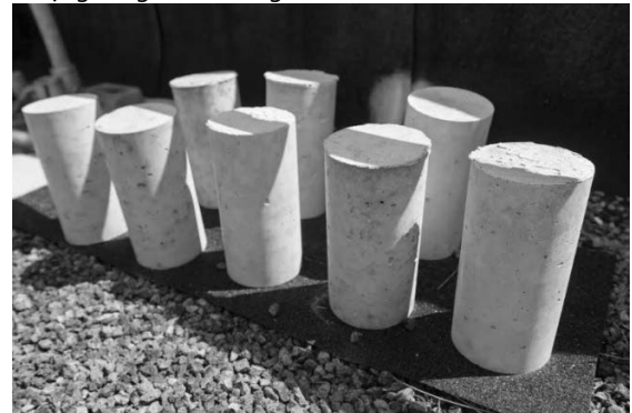
Hình 3. Các mẫu thử kiểm tra cường độ của các cấp phối GPC nghiên cứu
