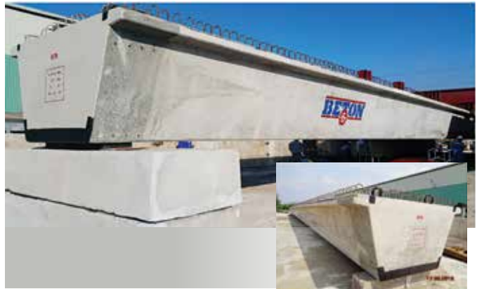
Sản xuất 2 dầm U38 bê tông HPC thử nghiệm tại nhà máy Beton6.
