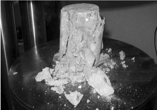
Hình 5. Bê mặt mẫu bê tông thí nghiệm bị phá hoại khi nén
