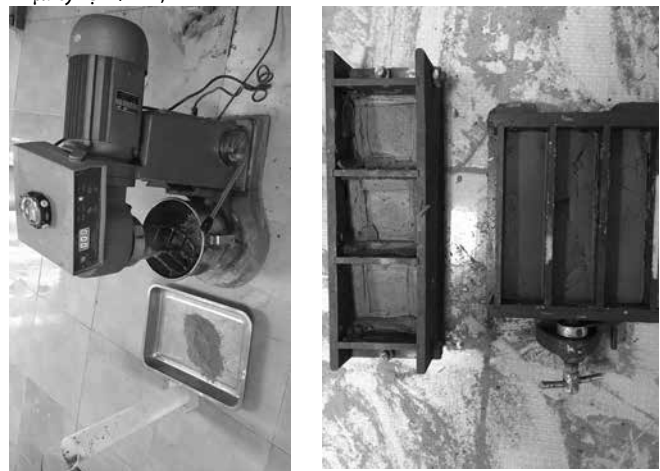
Hình 1: Thiết bị trộn và chế bị mẫu hỗn hợp XM đất
