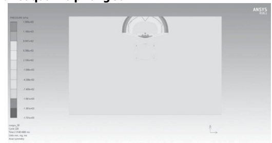
Hình 10. Quá trình mô phỏng nổ cho bài toán khảo sát tại thời điểm 2,314ms
