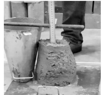
b) - Xác định độ sụt của hỗn hợp bê tông
