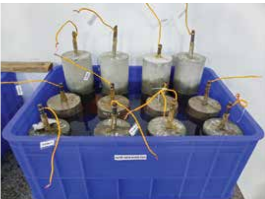
Bê tông cường độ cao có hàm lượng tro bay lớn (50-70% thay thế xi măng), bền trong môi trường Biển - Đề tài KHCN cấp Bộ Xây dựng-RD 25-20 (2020-2022)
