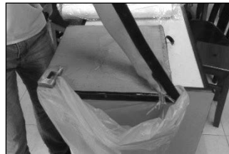
Hình 6. Cắt bã mía thành từng sợi có chiều dài từ 30 - 60 mm
