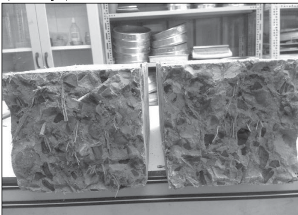
Hình 18. Phân bố của bã mía trong bê tông
