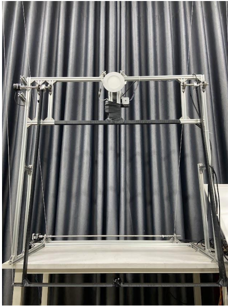
Hình 4. Mô hình đo vẽ đường phân bố cường độ ánh sáng được triển khai thực tế
