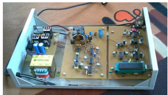
Hình 15: Hình ảnh bên trong và bên ngoài máy phân tích đa kênh đã thiết kế và chế tạo
