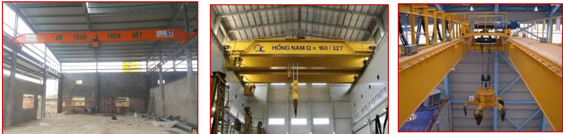
Hình 1. Vài loại cầu trục lắp trong nhà xưởng
