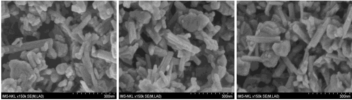
Hình 3.d. Ảnh FESEM của TiO 2 pha tạp 0.4 %wt Ag 2 O (M 3 ) Hình 3.e. Ảnh FESEM của TiO 2 pha tạp 0.6 %wt Ag 2 O (M 4 ) Hình 3.f. Ảnh FESEM của TiO 2 pha tạp 0.8 %wt Ag 2 O (M 5 )
