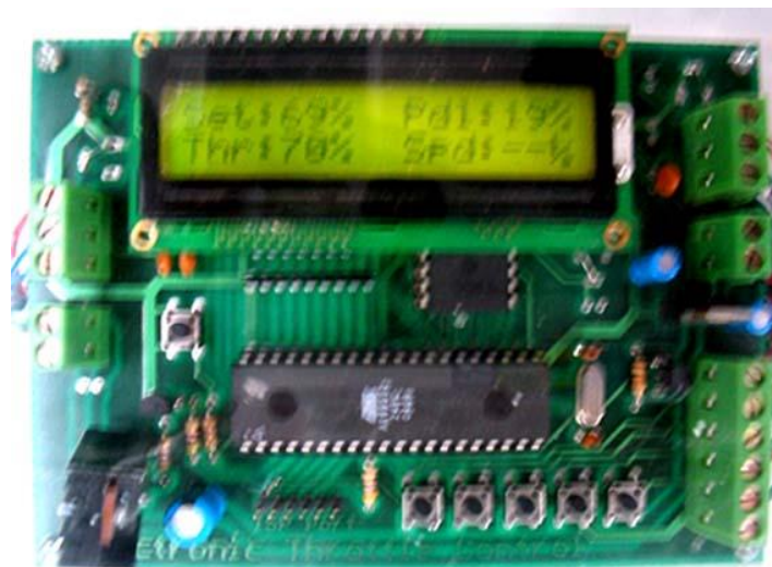
Hình 4. Mạch điều khiển bướm ga
