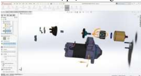
Hình 47. Tháo các bộ phận của công tắc từ
