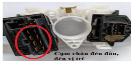
Hình 6. Công tắc tổng và bố trí chân của công tắc
