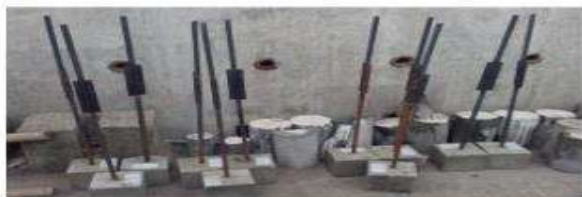
Hình 3.3. Mẫu bê tông cốt thép thí nghiệm
