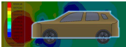
Hình 10. Phân bố áp suất nghiêng kính chắn gió 400
