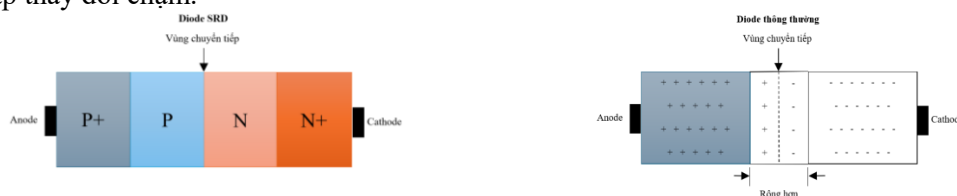
Hình 1. Cấu hình Step Recovery Diode và diode thông thường [8]
