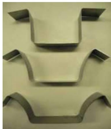
Hình 1. Hiện tượng đàn hồi sau khi uốn tạo hình biến dạng chữ U từ tấm phẳng.
