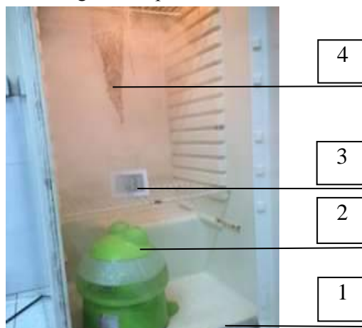
Hình 1. Hình ảnh bố trí thí nghiệm 1. Tủ BOD; 2. Máy phun sương; 3. Máy đo nhiệt độ và độ ẩm; 4. Lưới thu sương.
