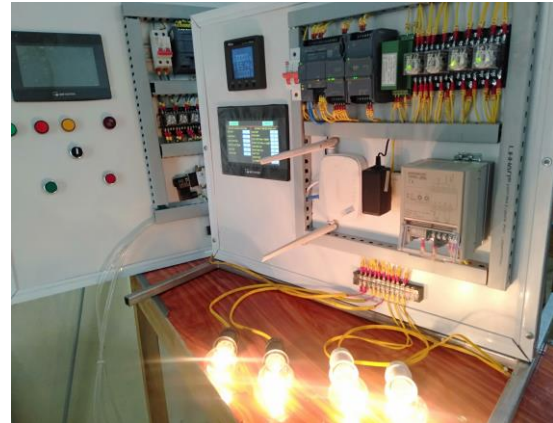
Hình 13. Tất cả các bóng vẫn sáng, nhưng đã được chiết giảm công suất
