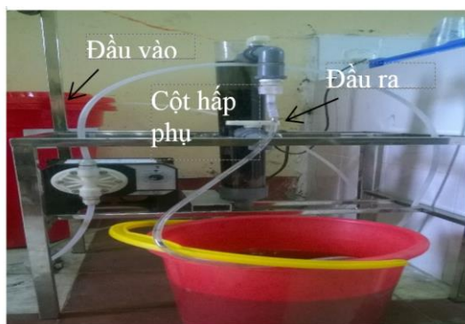
Hình 1. Mô hình hệ thí nghiệm cột hấp phụ chất hữu cơ
