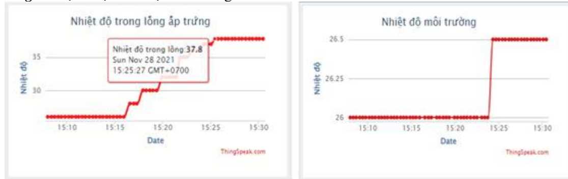
Hình 8. Đồ thị thời gian so sánh giữa nhiệt độ trong lồng ấp trứng và nhiệt độ môi trường
