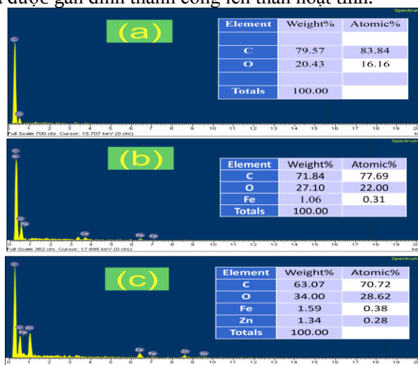
Hình 2. Phổ EDX của vật liệu THT bã mía (a) và THT bã mía gắn kết nano với tỉ lệ 20%: \text{Fe}_3\text{O}_4/\text{THT} (b) và \text{Fe}_3\text{O}_4@\text{ZnO}/\text{THT} (c)
