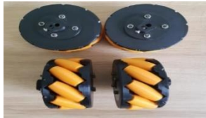
Hình 8. Bánh xe mecanum được chế tạo hoàn thiện bằng in 3D FDM
