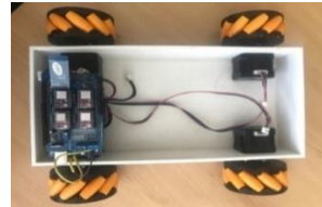
Hình 9. Robot tự hành sử dụng bánh xe mecanum được chế tạo bằng in 3D FDM
