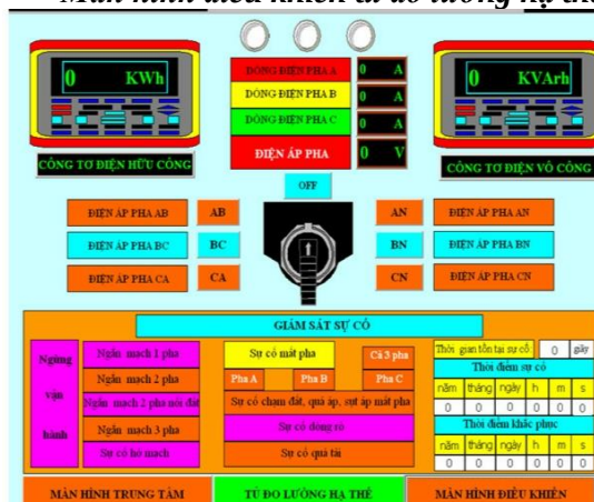
Hình 5. Màn hình điều khiển tủ đo lường hạ thế
