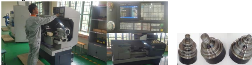
Hình 13. Thực tế vận hành lập trình gia công một số chi tiết trên máy tiện CNC CLK6140D/2
