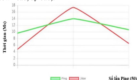
Hình 3. Biểu đồ biểu thị kết quả quá trình đo thông số Delay và Jitter sau một lần đo
