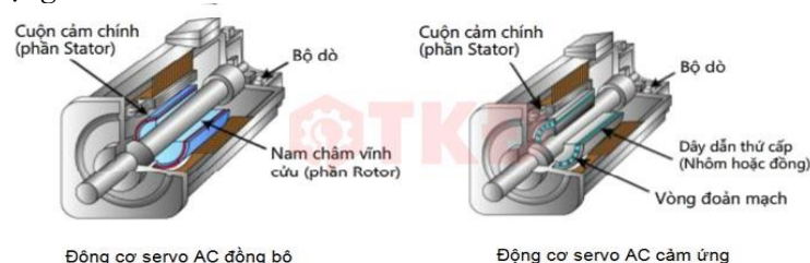
Hình 1. Cấu tạo của động cơ servo đồng bộ và cảm ứng
