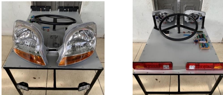
Hình 12. Mặt trước và mặt sau của mô hình điều khiển đèn xe thông minh
