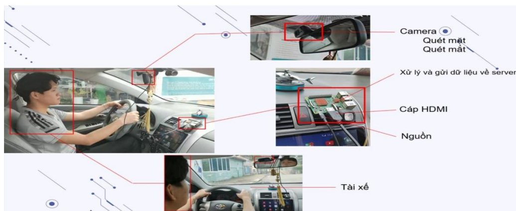
Hình 6. Ví trí lắp đặt thiết bị trên ô tô
