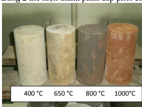
Hình 17. Ảnh hưởng của nhiệt độ bảo dưỡng đến màu sắc và sự hình thành vết nứt vật liệu sử dụng geopolymer (kế thừa của [48])
