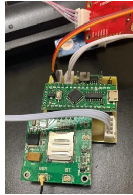
Hình 13. Mạch điều khiển sau khi hàn linh kiện
