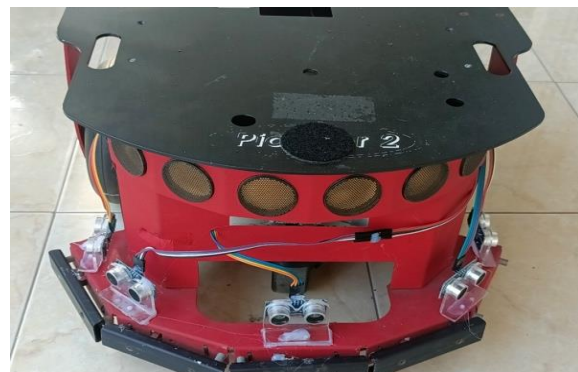
(b) Bố trí cảm biến siêu âm thực tế
