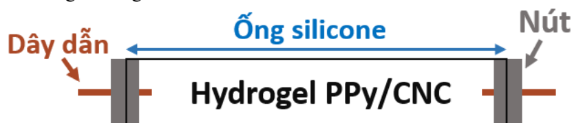
Hình 6. Mô hình minh họa ống silicone chứa hydrogel dẫn dùng trong khảo sát
