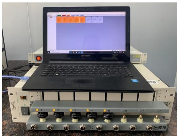
Hình 1. Hệ kiểm tra pin 8 kênh BTS4000-5V6A
