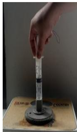
Hình 9. Thí nghiệm nén khí đẳng nhiệt
