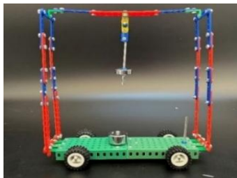
Hình 7. Mô hình "Con lắc giảm chấn"
