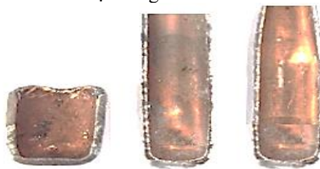
Hình 6. Sản phẩm thực nghiệm sau bước tóp bước 1 từ phôi trụ
