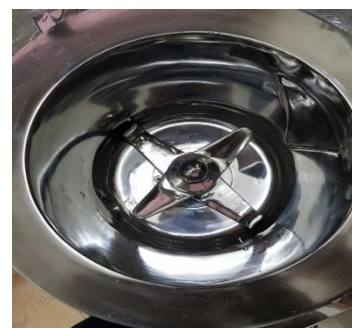
Hình 2. Cấu tạo buồng máy trộn tốc độ cao có gia nhiệt
