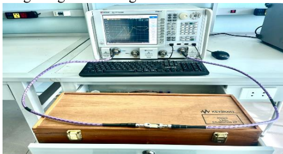
Hình 11. Triển khai đo kiểm mạch qua hệ thống máy phân tích mạng Vector – N5242A
