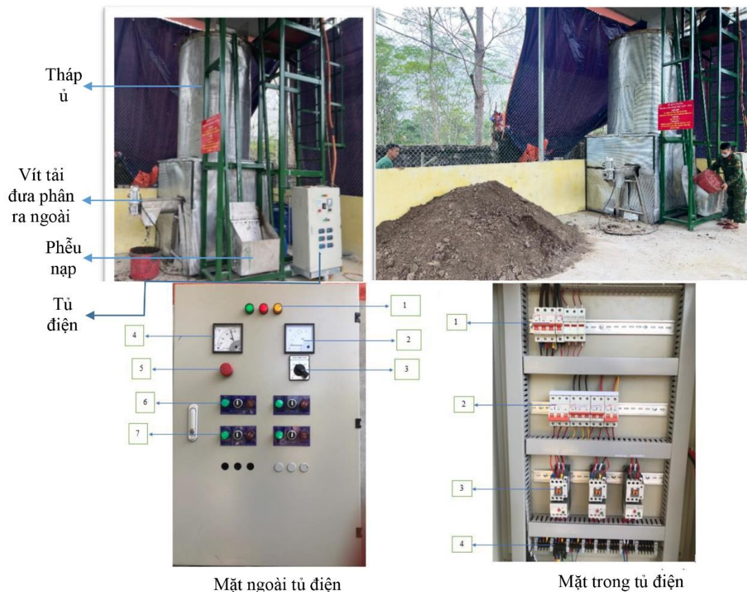
Hình 2. Hệ thống thiết bị ủ phân compost quy mô 100 - 200 kg rác/ngày
