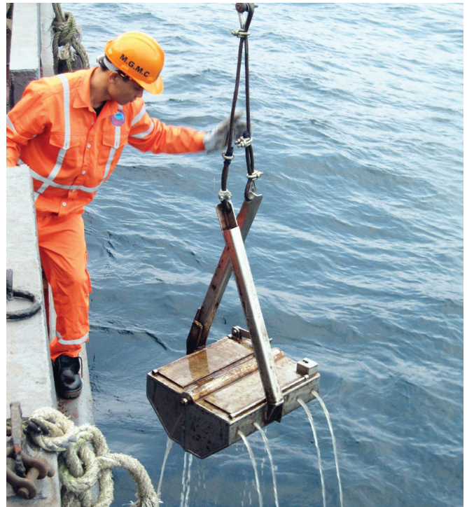
Công tác lấy mẫu trầm tích biển bằng cuộc đại dương cỡ lớn
