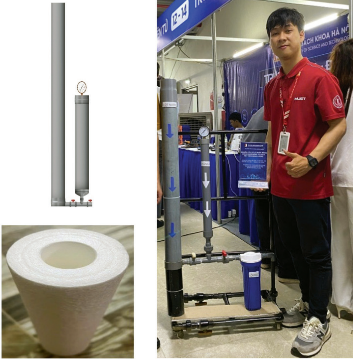
Hình ảnh về cấu tạo, loại màng lọc và hệ thống lọc màng năng lượng thấp [9]
