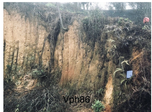
Hình 3. Vỏ phong hóa trên phức hệ granit Phia Bioc ở Hàm Yên
