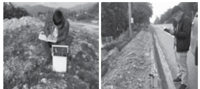
▲ Hình 2. Đo nồng độ phóng xạ radon trong không khí tại các khu đô thị vùng Cao nguyên đá Đồng Văn
